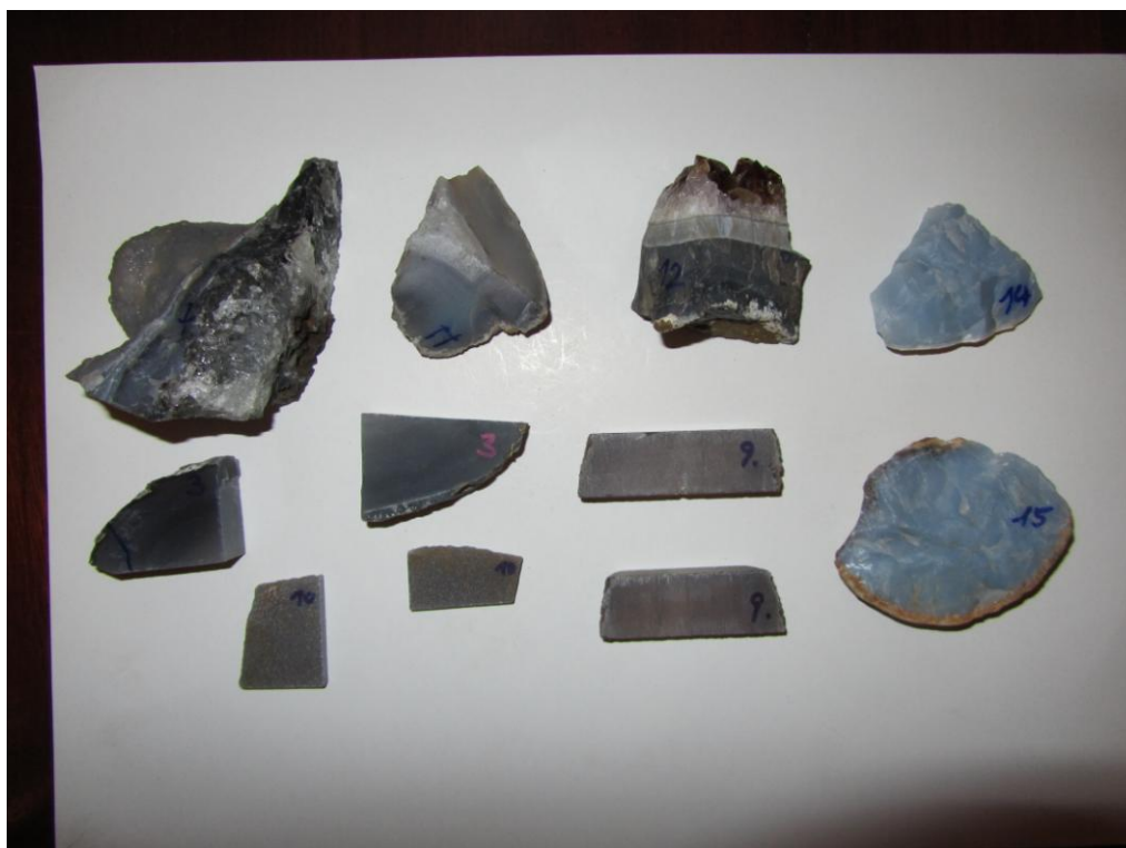
Figura 20 - Amostras após a irradiação por raios gama. O comprimento da imagem é de cerca de 30 cm.
