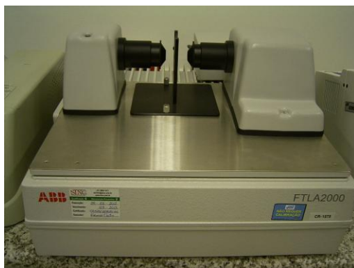
Figura 18 - Equipamento utilizado para a espectroscopia no infravermelho.
